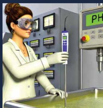
A nossa galvanoplastia contém diferentes substâncias químicas, como ácidos, bases sais metálicos e aditivos, que devem estar em equilíbrio para que a reação eletroquímica ocorra de forma adequada, sendo fundamental um rigoroso controle químico diário para controle do Ph e outros parâmetros
